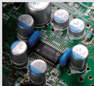
解码器的USB接收芯片Tenor BB公司的解码芯片PCM1792 8802L，支持24Bit/192kHz
