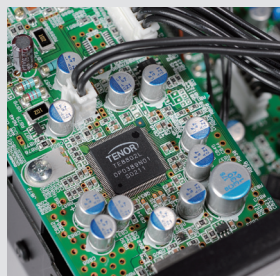
解码器的USB接收芯片Tenor BB公司的解码芯片PCM1792 8802L，支持24Bit/192kHz
